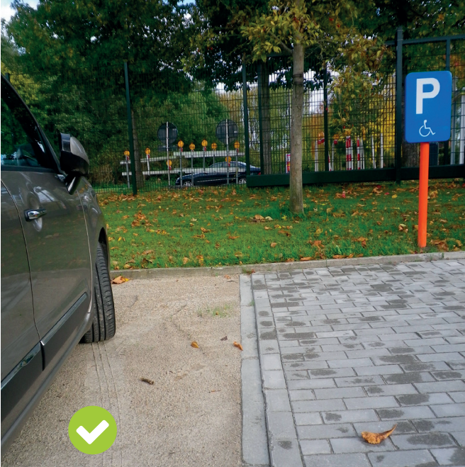
Obstakels | Obstakels zoals verkeerspalen werden in de beplanting geplaatst en niet in de verharding. © Dan Slootmaekers
