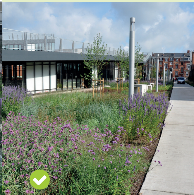
Na het planten werd de grond afgedekt met een laag lavakorrels (8/16) van 7 cm dik. ©VVOG
